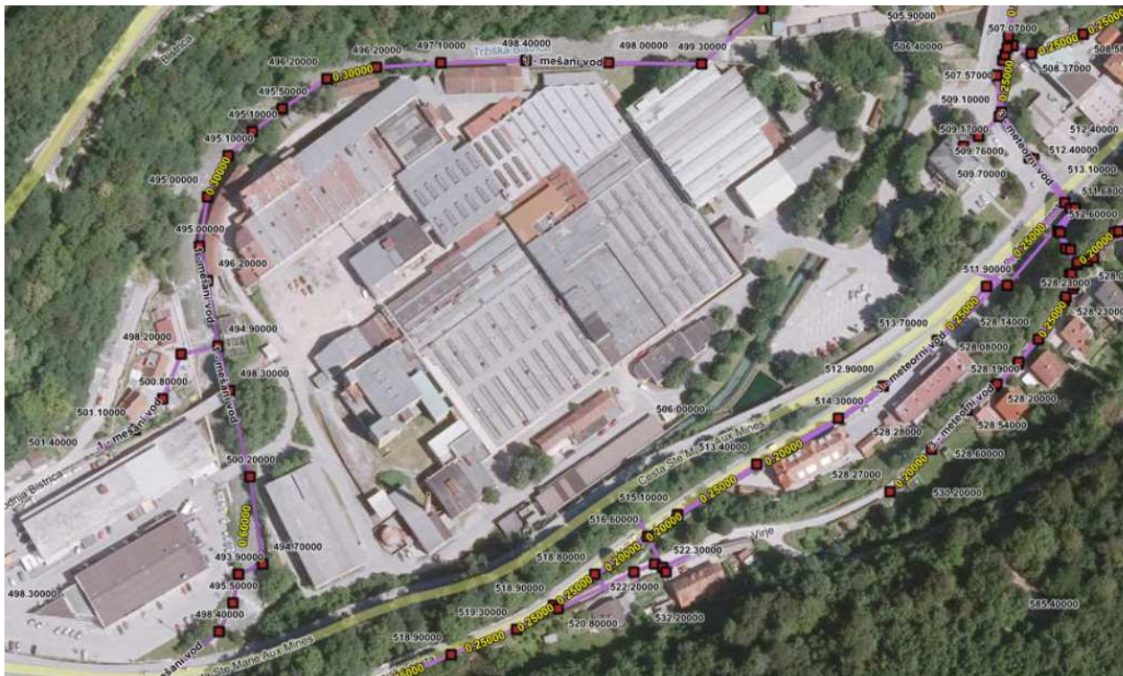
Slika 6: Obstoječa kanalizacija (vir:PISO).
