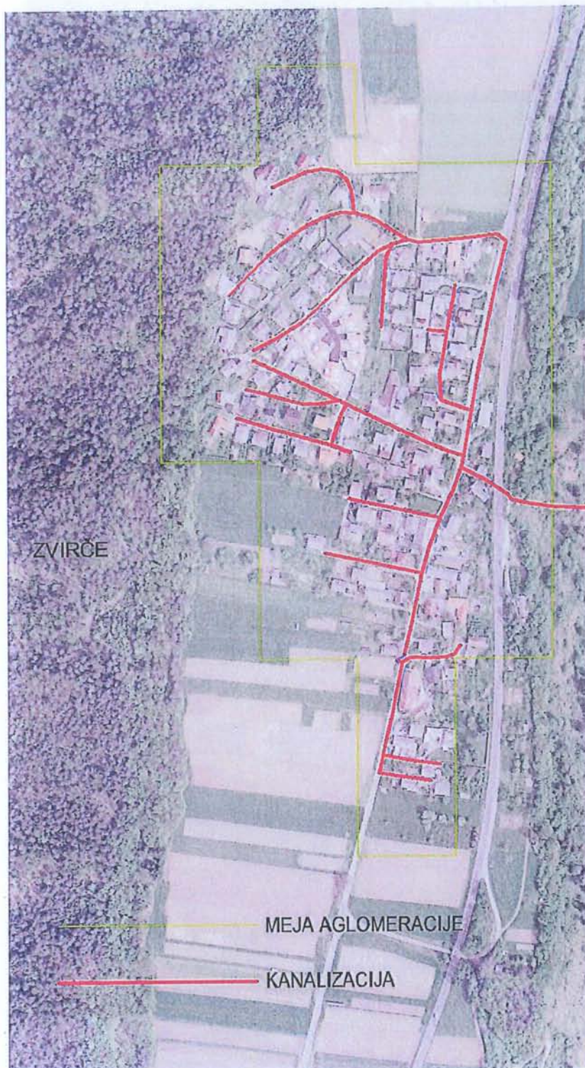
Slika 7: Trasa zgrajene kanalizacije v Zvirčah
